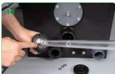
Теперь вставьте уплотнительные кольца в корпус УФ и вставьте их вместе с деталью распорки в возникшее отверстие фильтра.
