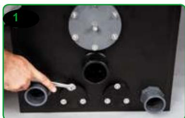
Снимите 3 гайки и подкладочные шайбы от заглушки, смонтированной в фильтре. Болты (резьбовые стержни) крепко соединены с фильтром и не снимаются.
