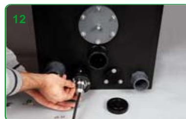
Закрутите три выступающие резьбы подкладочными шайбами и гайкой...
