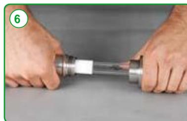
После полного отвинчивания резьбы вытяните болтовое соединение кабеля, включая излучатель из защитной трубки.
