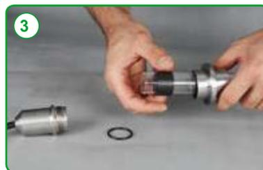
После изъятия излучателя из защитной трубки сдвиньте резьбовой фланец, находящийся на защитной трубке, назад по направлению к стеклянной колбе. Потом снимите...
