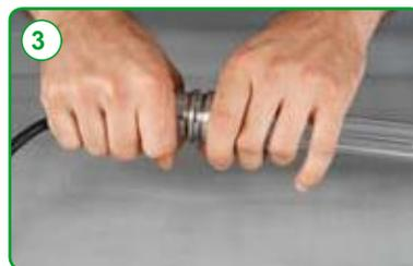
**ВНИМАНИЕ:** Всегда вынимать штепсельную вилку перед открытием прибора EVO Blue Light UVC! Отпустите болтовое соединения кабеля от резьбового фланца, отвинчивая болтовое соединение кабеля против часовой стрелки.
