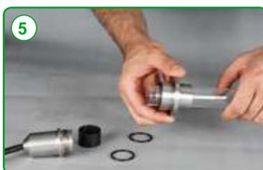
перед тем как иметь возможность сдвинуть резьбовой фланец от защитной трубки
