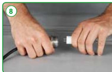
Теперь осторожно отпустите штепсельное соединение между болтовым соединением кабеля и излучателя.
