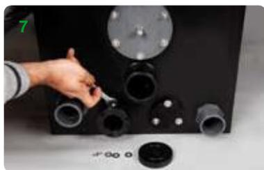
Для начала наденьте подкладочные шайбы на резьбовые стержни и прикрутите три гайки
