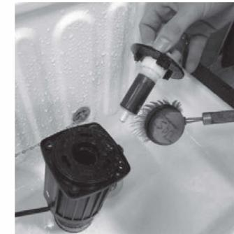
3. Выньте ротор и промойте его водой и щеткой.
