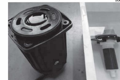
4. Установите корпус насоса в вертикальное положение и заполните его мягким средством для удаления известкового налета (например, чистящим уксусом). Погрузите ротор в пластиковую чашу/контейнер, наполненный тем же средством для удаления накипи, и оставьте на 24 часа. Через 24 часа промойте водой и снова соберите насос.
